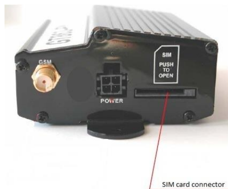
Рисунок 16 Установка SIM -карты
