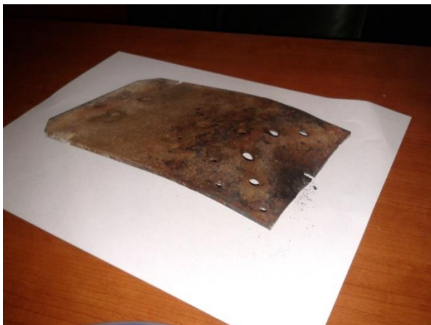
Фото 1 Деформированная решетка и прогоревшая камера сгорания
